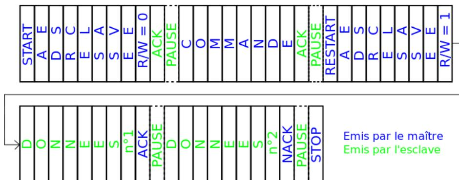
Figure 26 : protocole de communication I<sup>2</sup>C
