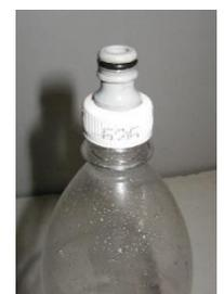
Figure 7 : Assemblage de la tuyère au corps de la fusée
