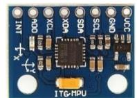
Figure 23 : Module MPU 6050
