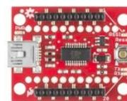
Figure 34 : Adaptateur Xbee USB
