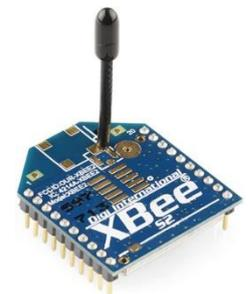
Figure 31 : Module Xbee
